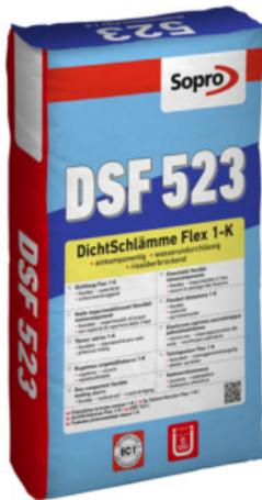
**Badigeon minéral, flexible, monocomposant, pour la réalisation - sous carrelage - d'une étanchéité assurant un pontage des fissures. Pour l'étanchéité en intérieurs selon DIN 18534 et l'étanchéité des bassins et réservoirs selon DIN 18535.**
